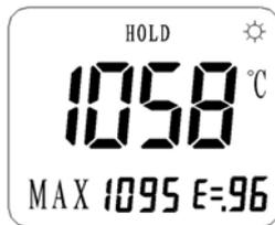
当数据存储打开时，仪器测温开关的软件锁打开，仪器进入存储测温模式。仪器显示如下图。此时不再需要按测温开关，仪器一直处于测温状态，测温开关此时成为存储开关，按一下便会存储当前所测温度值及相关信息（包括：实时值、最大值、最小值、平均值、地址、时间、发射率、温度单位），存储地址自动加1。如在30秒内对仪器无任何操作，仪器将自动关机。
